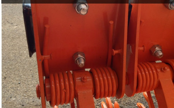
Posizione molla per minor tensionamento
