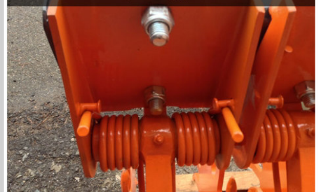
Posizione molla per maggior tensionamento
